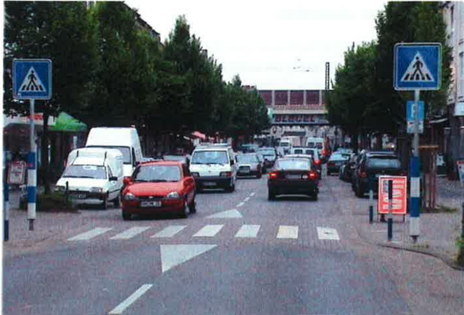
Abbildung 9: Mögliche Gestaltung / Markierung des Fußgängerüberweges
